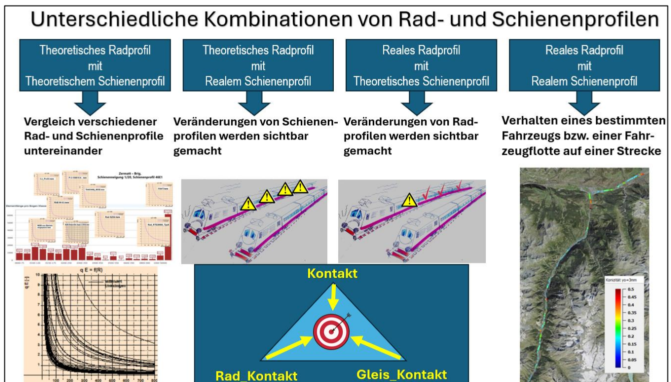
Abbildung 11: Unterschiedliche Paarungsmöglichkeiten von Rad- und Schienenprofilen und die 3 dazu verwendbaren Kontaktprogramme
