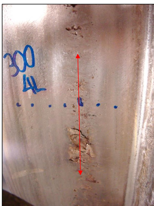
Figura 13: Direzione di apertura della cricca ed esempio di cricche RCF 3 (a sinistra, Roland Müller e a destra, EN 15313); la freccia rossa indica il piano di misura (Zona 3)
