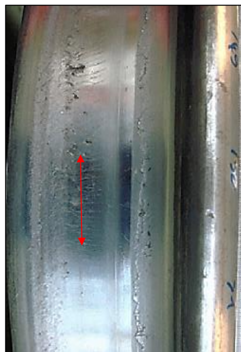
Figura 13: Direzione di apertura della cricca ed esempio di cricche RCF 3 (a sinistra, Roland Müller e a destra, EN 15313); la freccia rossa indica il piano di misura (Zona 3)
