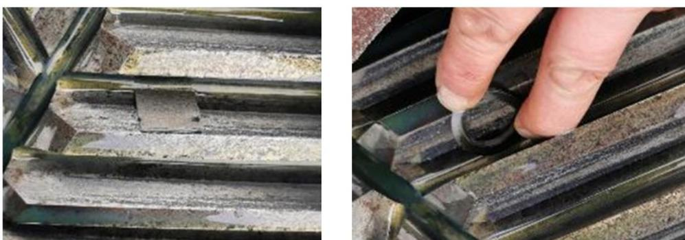
Figure 94 - Prélèvement d'un film d'huile à l'aide d'un feutre (à gauche) ou d'un tampon et d'un cadre pour délimiter une surface définie (à droite)
