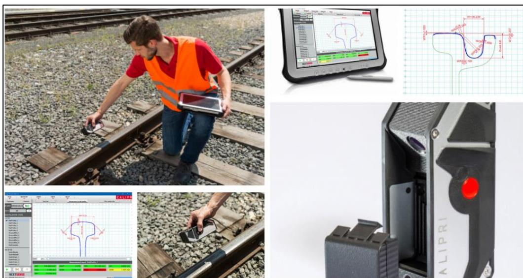
Figure 91 - Appareil de mesures Calipri
