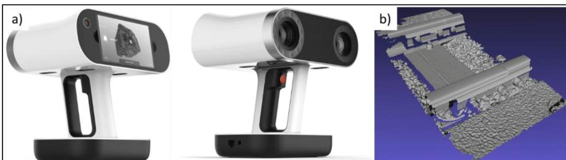
Figure 92 - 3D-Scanner manuel: a) Artec LEO 3D-Scanner b) Tronçon de la voie ferrée scannée
