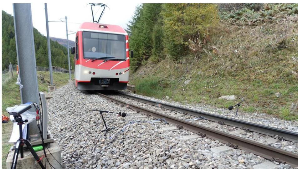
Figure 65 - Instrumentation et passage d'une rame automotrice
