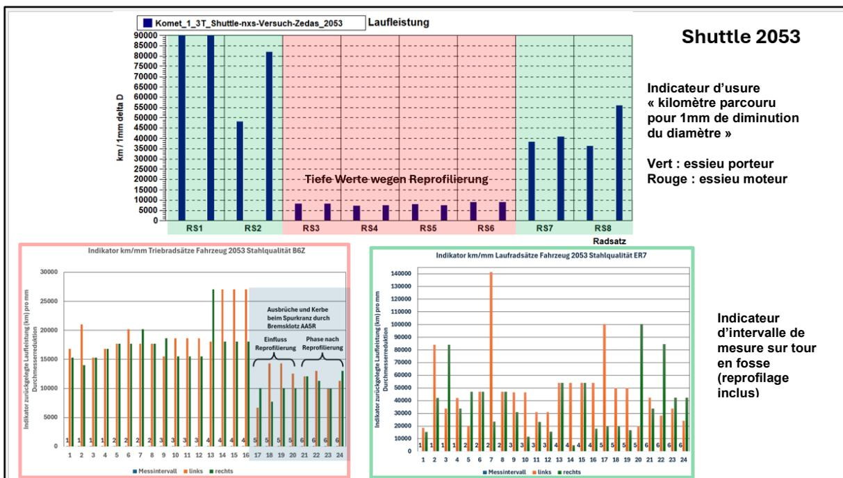
Figure 3 - Indicateur « Nombre de km par réduction de diamètre de 1 mm », Shuttle 2053
