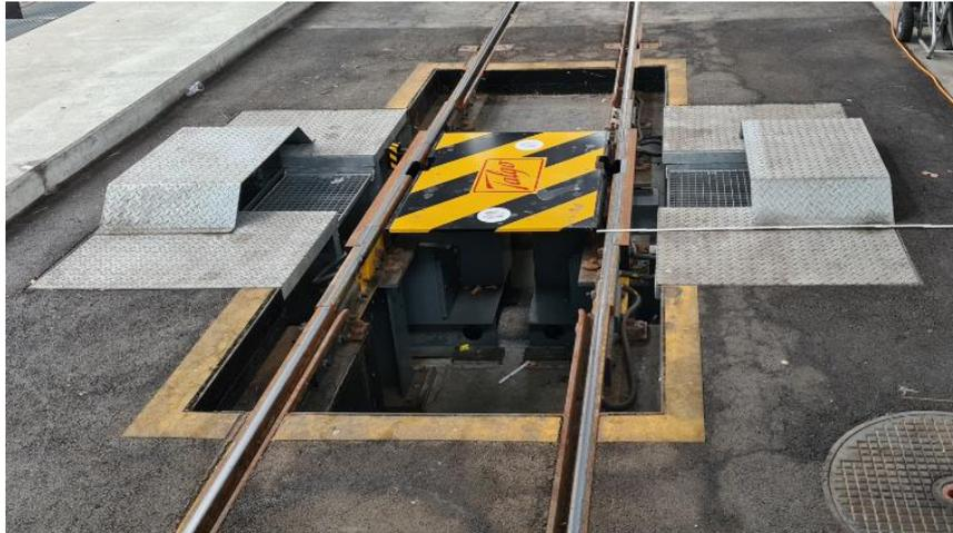
Abbildung 1: Überfahrmessanlage von TALGO für die Radprofile. [1]
